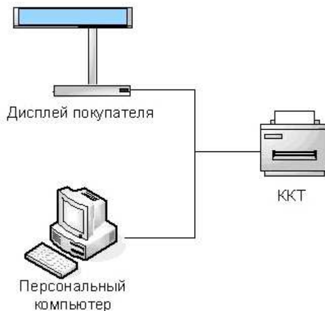
Рисунок 3. Подключение управляющих устройств к ККТ
