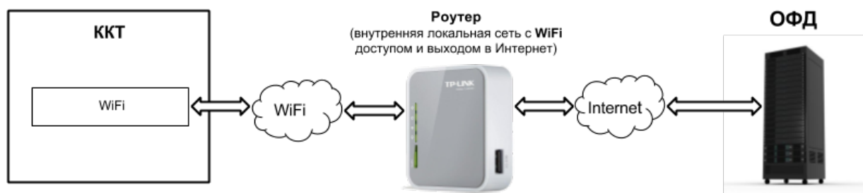
Подключение ККТ к техническим средствам ОФД при работе по интерфейсу WiFi
